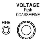
调整输出电压值，对所选中的通道做设定值的调整，按下旋钮开关可进行粗调或细调设定。
