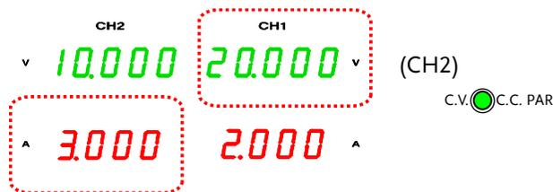
CH2 (从)电压 读 CH1 表头显示输出电压。在以上情况, 实际输出是 20.000V。
