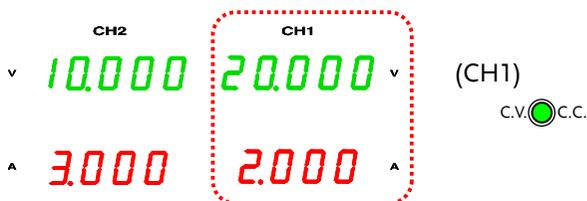
电压值 读 CH1 表头显示输出电压值。在以上情况，实际输出是 20.000V。
