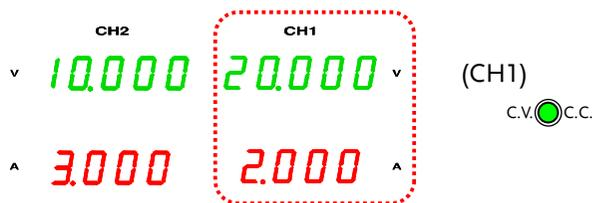
CH1 (主)电压 读 CH1 表头显示输出电压。在以上情况, 实际输出是 20.000V。
