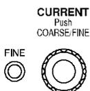
调整输出电流值，对所选中的通道做设定值的调整，按下旋钮开关可进行粗调或细调设定。
