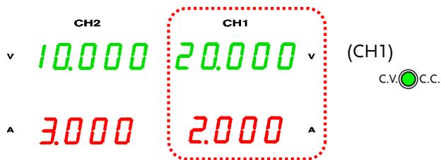
电压值 读 CH1 电压表头的 2 倍。在以上情况，实际输出是  $20.000 \times 2 = 40.000V$ 。
