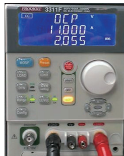
圖14 3311F/G 的BMS過放電流測試結果(連續STEP脈衝)
