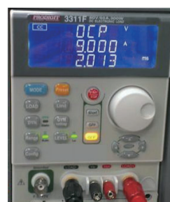
圖9 3311F/G 的BMS過充電流測試結果(連續STEP脈衝)
