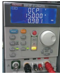
圖7 3311F的BMS過充電流測試結果 (單脈衝)
