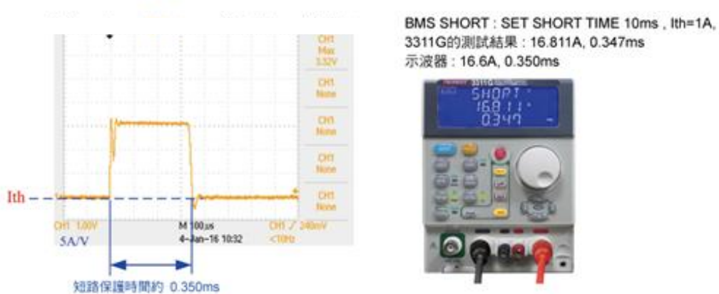
圖2.4 4000mAh Power Bank 實際短路測試波形
