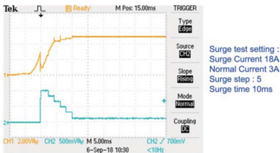
5V 電源開機時 18A 瞬間啟動電流測試
