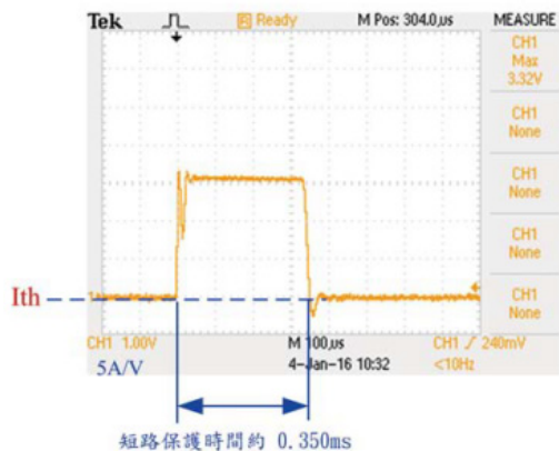
圖2.4 4000mAh Power Bank 實際短路測試波形
