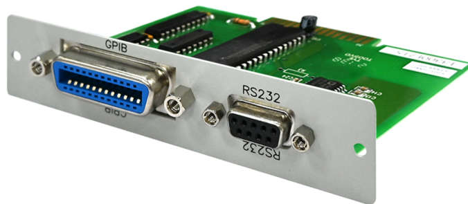
圖 2-3 3305G GPIB &amp; RS232 連接埠圖
