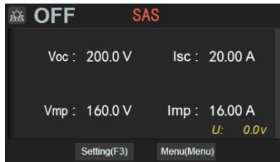
PV SAS 待機界面
