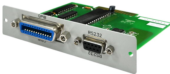
圖 2-2 36000E 系列 GPIB & RS232 連接埠圖
