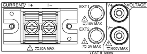
Beschreibung V + Der positive Spannungseingang (+), 600V für den Eingang auf der Rückseite.
