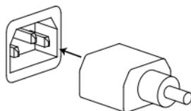
Hinweis: Vergewissern Sie sich, dass der Schutzkontakt am Netzkabel mit der Sicherheitserde verbunden ist. Dies hat Auswirkungen auf die Messgenauigkeit.
