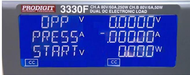
4.12.3 OPP test function parameter setting key.
