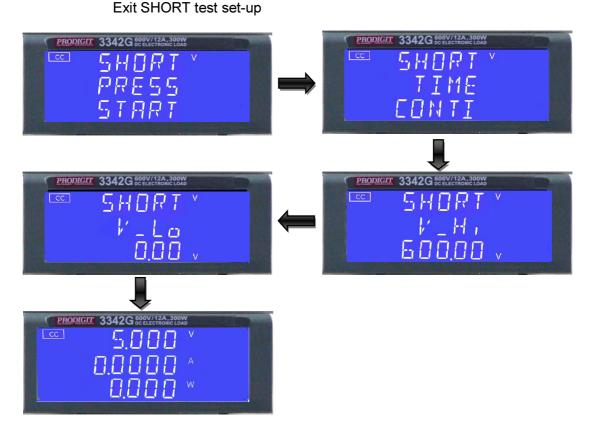
setting the short test time, The LCD display show 「SHORT」 on upper 5 digits LCD display, shows 「TIME」 on middle 5 digits LCD display, lower 5 digit LCD display 「CONTI」, the unit is "ms".
